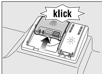
Ячейка с моющим средством открывается автоматически в зависимости от выбранной программы в самый подходящий для этого момент времени. Порошкообразное или жидкое моющее средство распределяется внутри машины и затем растворяется. Таблетка моющего средства падает в машину и там растворяется.
